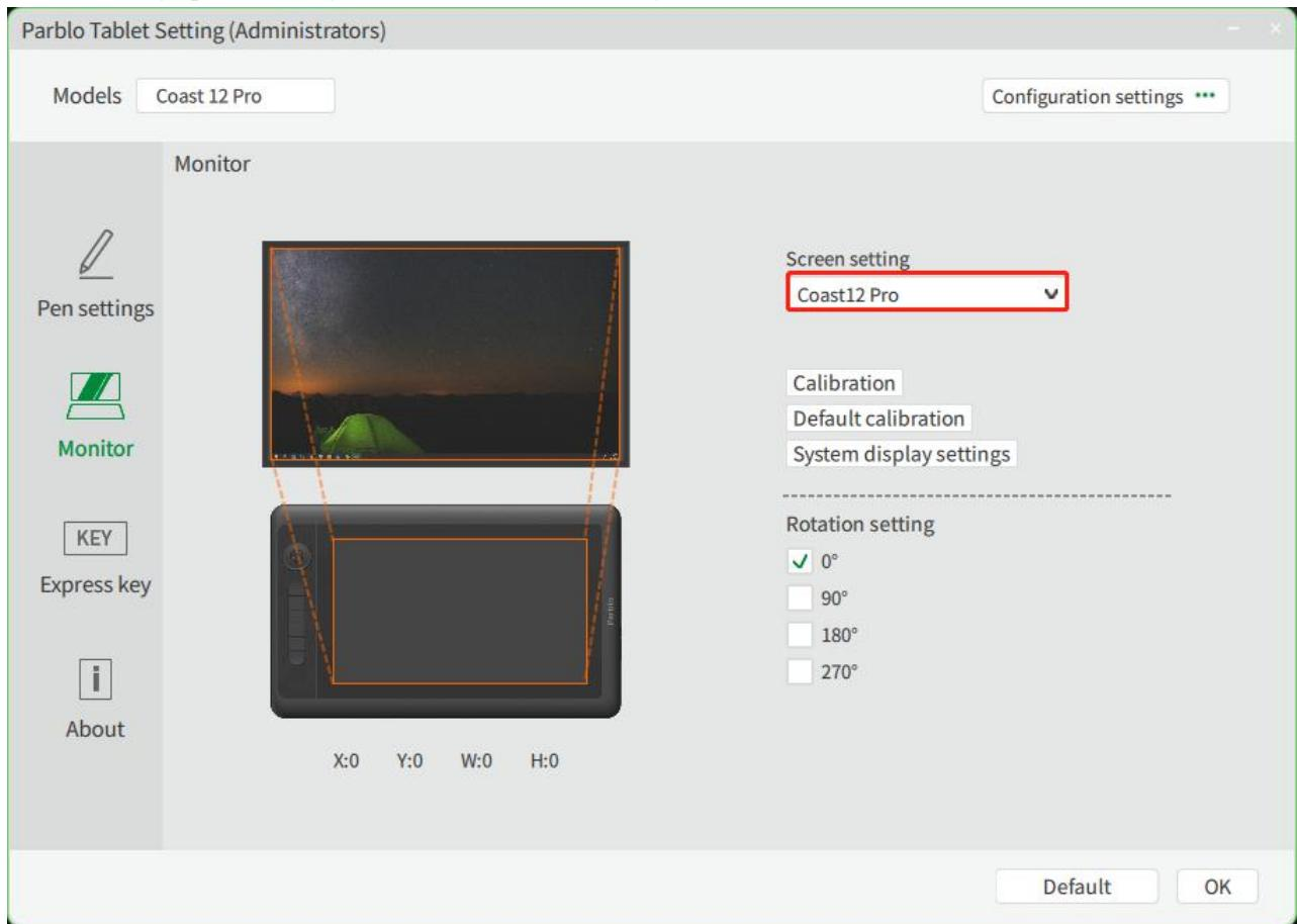
Figure 3-3 Display Mapping
